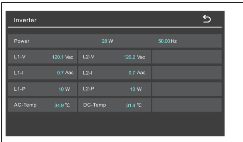
Potencia y frecuencia de generación del inversor.
